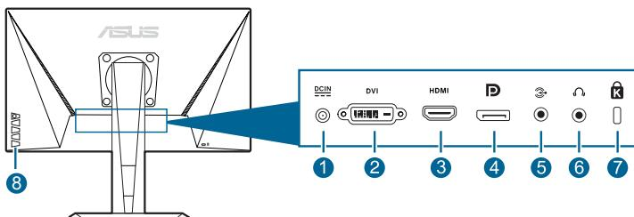
1. **DC-IN 接口。** 此端口连接电源线。
